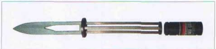
Die Angel und die dahinter liegende Gasfeder wären zu lang für einen normal dimensionierten Griff.
