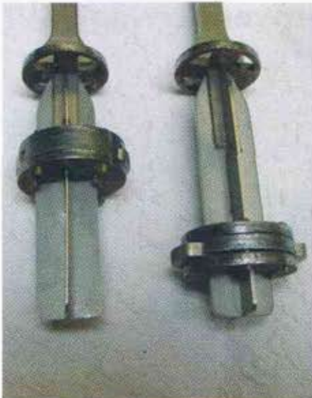
Die geflügelte Angel erforderte einen aufwändigen Auslösemechanismus.
