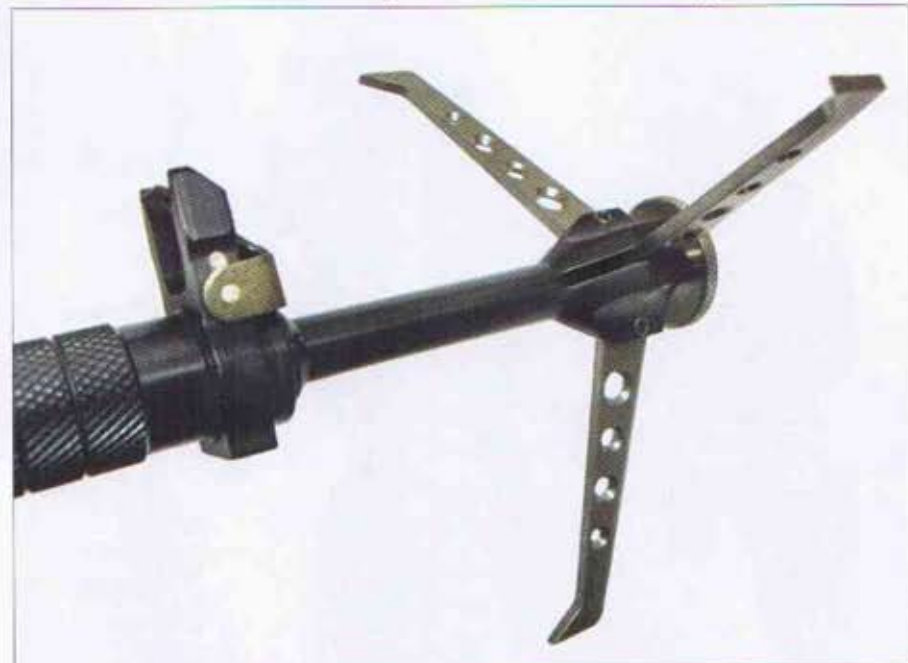
Er weist allerdings keine ausreichend dimensionierte Befestigungsmöglichkeit für ein Seil auf.
