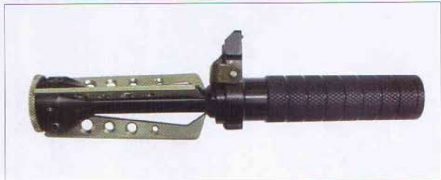
Der Wurfanker lässt sich zu Transportzwecken zusammenklappen.
