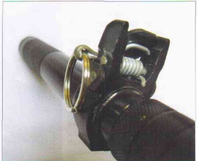
Da auch das Griffrohr den gleichen Durchmesser aufweist, lassen sich die Klingen austauschen.
