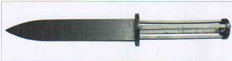
Bei diesem Prototyp besteht die Angel aus vier zusammengesteckten Vierkantstäben.
